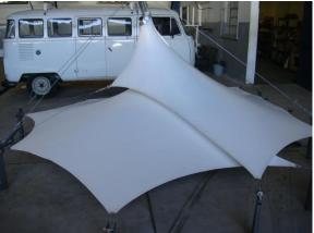
Já com a forma da membrana definida e validada, os cálculos estruturais para a membrana foram desenvolvidos, considerando-se carregamento devido a retesamento e ação do vento ( lateral e longitudinal) de acordo com a NBR-6123/99.
